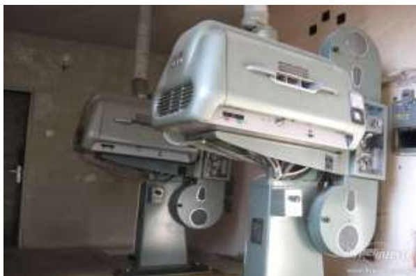
Profesionální stabilní promítací stroje Meopton 4, vyráběné v 60. letech obsahovaly Křížkové obloukové lampy, později xenonové výbojky
