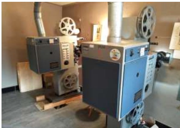
Naše promítací stroje Meo 5 XB, vyráběné v 80. letech mají xenonové výbojky o výkonu 2KW, automatické prolínání, otočný karusel se třemi objektivy pro snadné formátování obrazu, snímač analogové optické zvukové stopy DolbyStereo a možnost převíjení filmu přímo na strojích. Volitelně je bylo možno osadit snímačem prostorového zvuku DolbyDigital, případně DTS či SDDS. (instalovala hlavně multikina)
